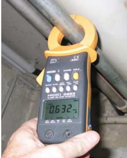
Sl. 3. Merenje lutajućih struja kroz vodovodnu cev pomoću amper klešta
