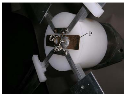
Sl. 11. Fotografija realizovanog balun-a sa koncentrisanim parametrima novog tipa antene sa ukrštenim dipolima.
