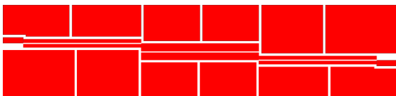
Слика 8. Микротракасти филтар са спрегнутим резонаторима и острвима у околни.
