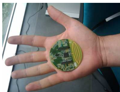
Sl. 3 Razvojno elektronsko kolo predajnika
