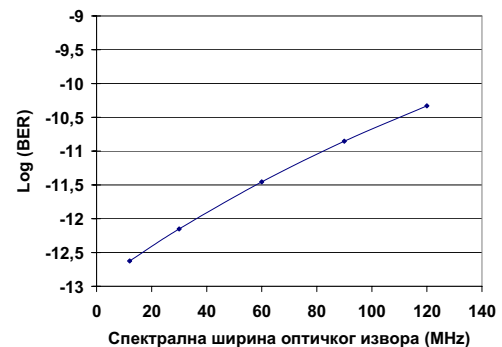
Сл. 5. Зависност оствареног BER 10G-PON система од спектралне ширине оптичког извора 10G-PON OLT.
