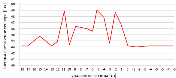
Слика 5. Излаз светлосног сензора као функција раздалјине између пролазећих возила и чвора
