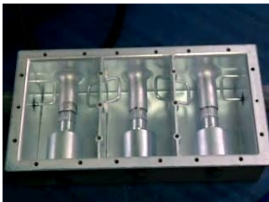
Sl. 2. Unutrašnjost filtra sa spregnutim rezonatorima za UHF opseg.
